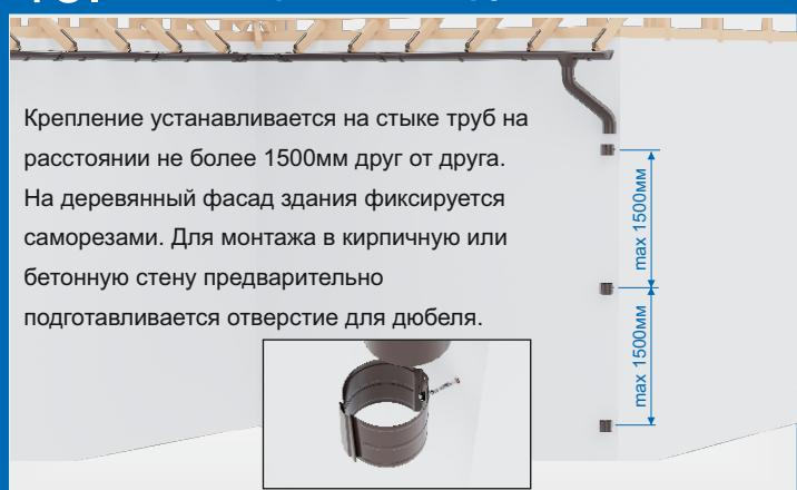
Крепление устанавливается на стыке труб на расстоянии не более 1500мм друг от друга. На деревянный фасад здания фиксируется саморезами. Для монтажа в кирпичную или бетонную стену предварительно подготавливается отверстие для дюбеля.
