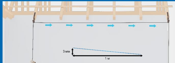
Желоба устанавливаются под уклоном, задавая направление потока воды в сторону водосточных труб. Уклон желоба должен составлять не менее 3мм на погонный метр.
