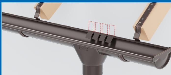
Выпускная воронка устанавливается на смонтированный желоб по разметке. Воронка заводится в барашек и проворачивается до конца, для фиксации загибаются резные фланцы.
