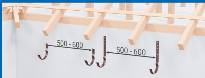
Держатели желоба устанавливаются на стропила или карнизную доску до монтажа кровельного покрытия.
