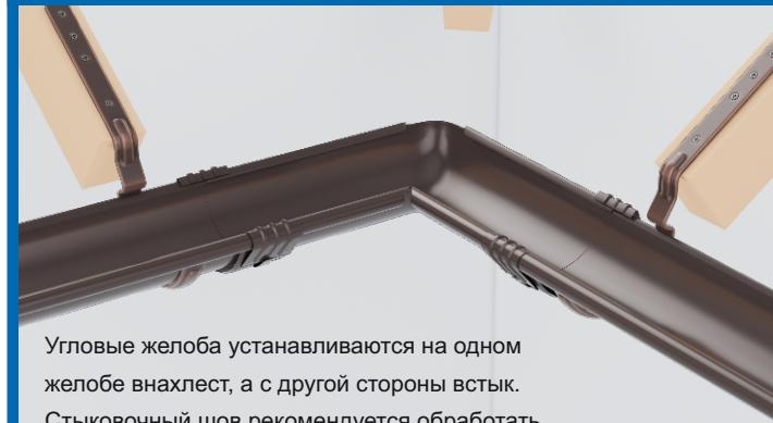
Угловые желоба устанавливаются на одном желобе внахлест, а с другой стороны встык. Стыковочный шов рекомендуется обработать герметиком, а затем закрепить соединителем.
