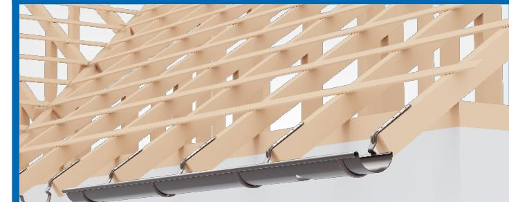
Для установки необходимо завести крюк держателя в барашек желоба и повернуть, слегка скав край желоба, фиксируя его в держателе до защелкивания.
